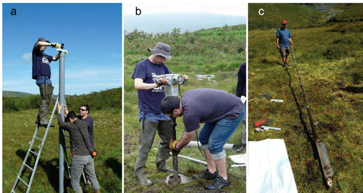
**Figura 2.** Técnicas utilizadas para la extracción de los registros sedimentarios de La Molina. a: Extracción de MOL2 (0 – 260 cm de profundidad) utilizando un tubo de PVC. b: Extracción de MOL4 m1 (367 – 467 cm de profundidad) mediante un martillo de percusión Eijkelkamp. c: Extracción de MOL6 mediante una sonda Rusa. En este sondeo se extrajeron 9 registros de 0,5 m y un registro de 0,49 m, obteniendo una secuencia de 0 a 499 cm de profundidad
