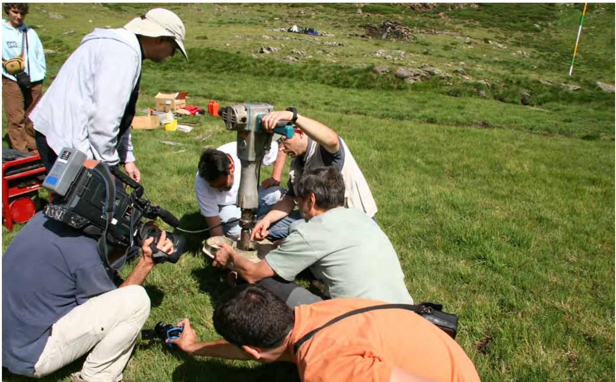
Figura 3. Proceso de obtención del testigo sedimentario en Estany d'Estanilles
